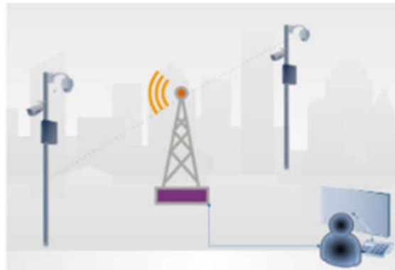
Figura 3: Conexiones enlace punto/multipunto a sala de control
